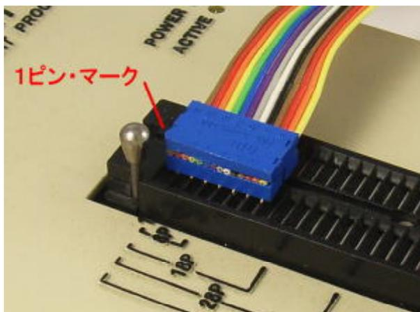
ケーブルのDIPコネクタの1ピン・マークを書き込み器ソケットの左上に合わせて装着します。
