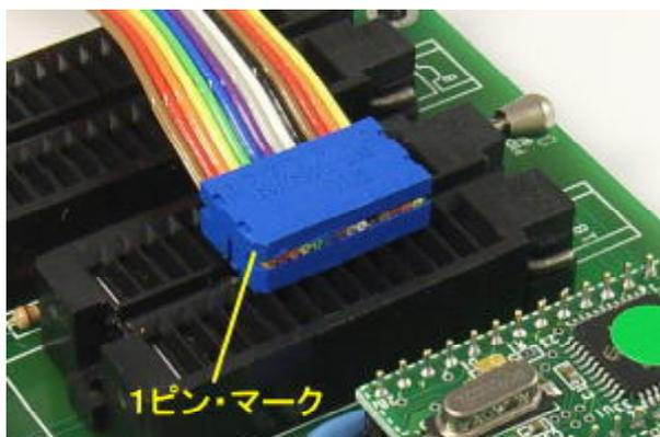
ケーブルのDIPコネクタの1ピン・マークを書き込み器の28ピン・ソケットの6番ピンの位置に合わせて装着します。(下の2ピン分は空きになります。)
