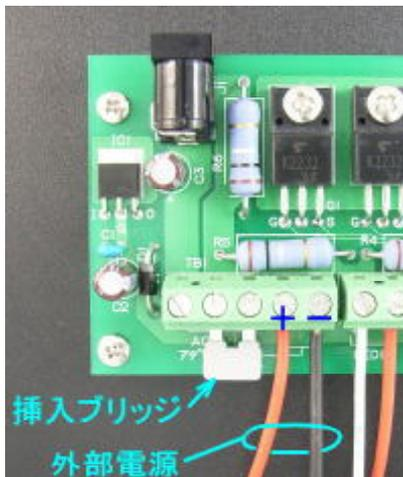
外部電源からリード線で端子台に接続する場合は、挿入ブリッジを下の図の位置に固定してください。リード線は+側と-側を下図の位置に接続してください。
